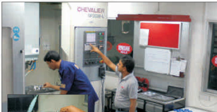
Размер станины VMC 500x700 мм.
